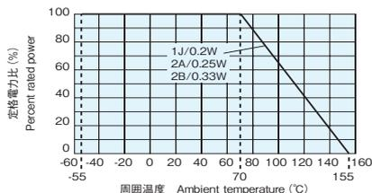
周囲温度70℃以上で使用される場合は、上図負荷軽減曲線に従って、定格電力を軽減して御使用ください。
